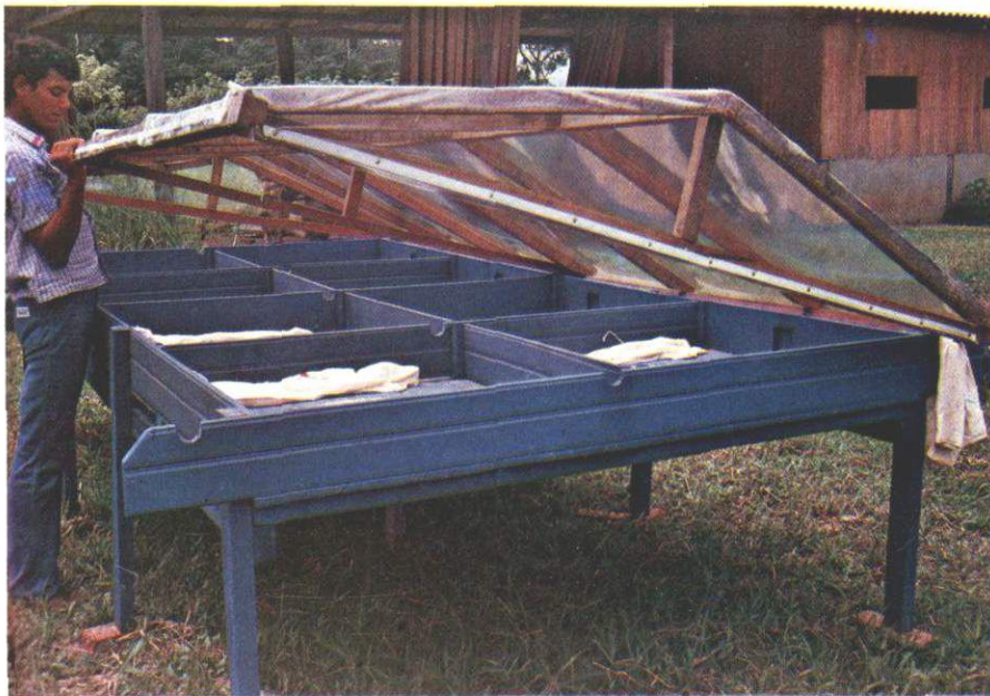
FIG. 38. Secador de madeira com cobertura plástica.
