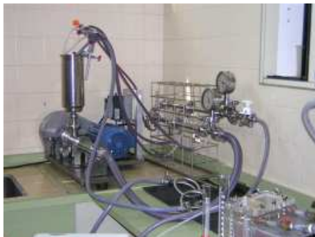
Figura 5. Sistema de microfiltração com membranas cerâmicas Foto: Virgínia Matta
