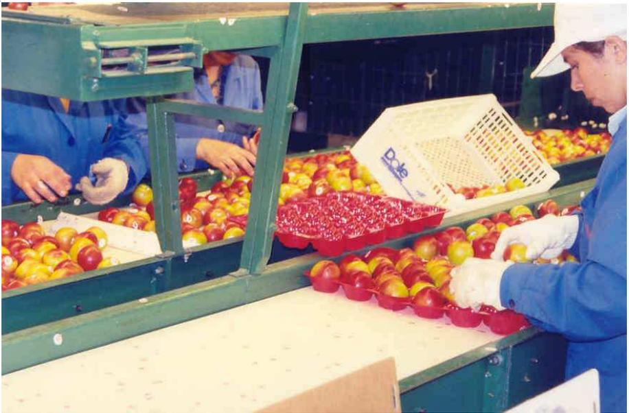
**Figura 4.** Sistema de classificação manual por calibre de nectarinas em bandejas.
