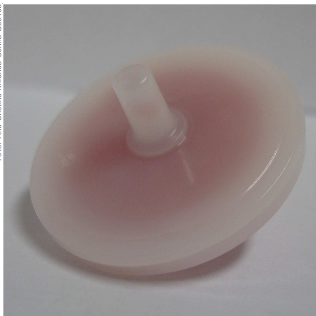
Figura 2. Retenção das antocianinas em membrana do tipo Millex® (0,45um)
