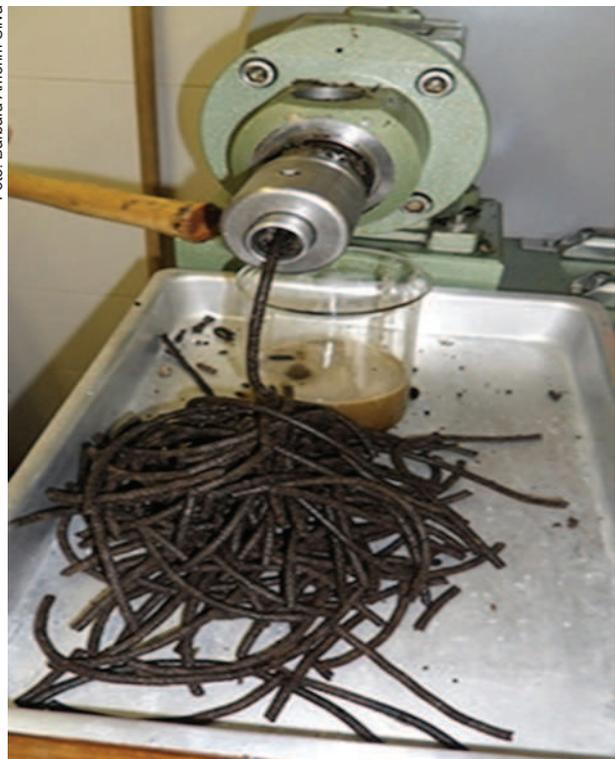
Figura 2: Processo de extração do óleo para obtenção das tortas de mamona e pinhão manso.
