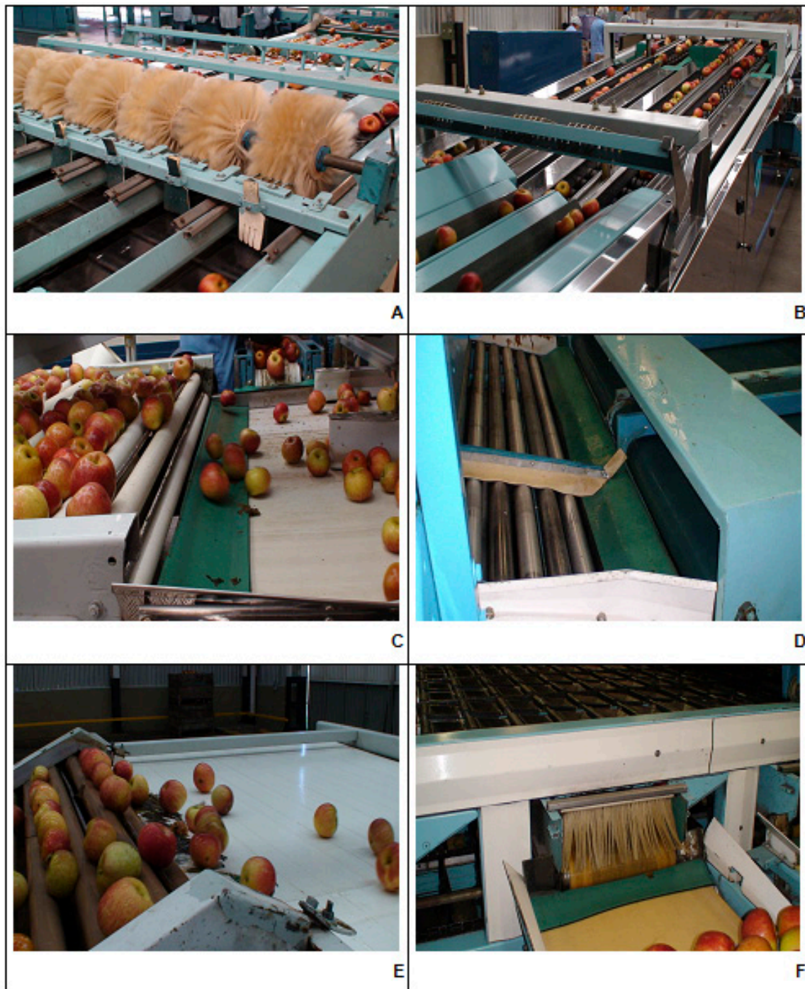
Fig. 7. Pontos de transferência: sincronizador – calibrador na linha 1 (A) e na linha 2 (B), mesa de seleção – esteira na linha 2 (C), esteira – elevador de roletes rígidos na linha 1 (D), queda esteira rolante na linha 2 (E) e esteira – mesa de embalagem na linha 1 (F).
