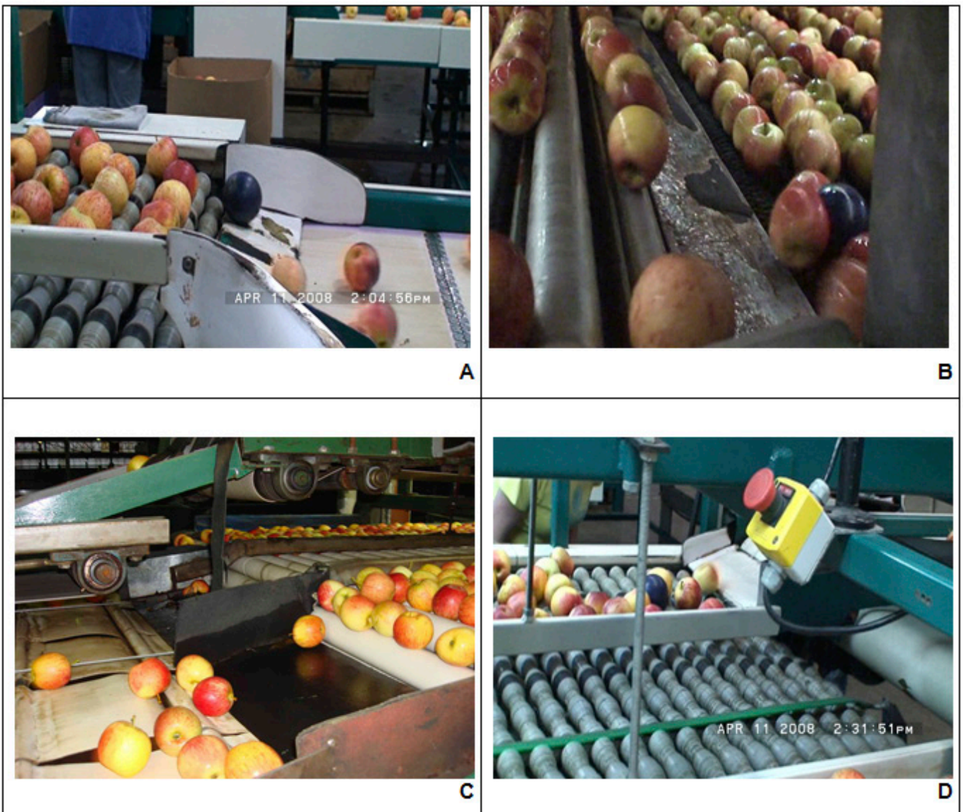
Fig. 11. Pontos de transferência: mesa de seleção – esteira na linha 6 (A), elevador de roletes – secador na linha 6 (B), esteira – mesa de seleção na linha 6 (C), mesa de seleção – flaps na linha 3 (D).
