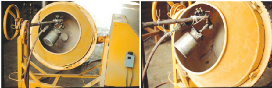
Figura 1. Betoneira modificada para realização de estudos de peletização de sementes. O equipamento é composto por bojo de fundo arredondado, de material plástico e acionado por manivela. O cimentante é aplicada por aspersão, utilizando uma pistola de pintura a ar comprimido de baixa pressão.
