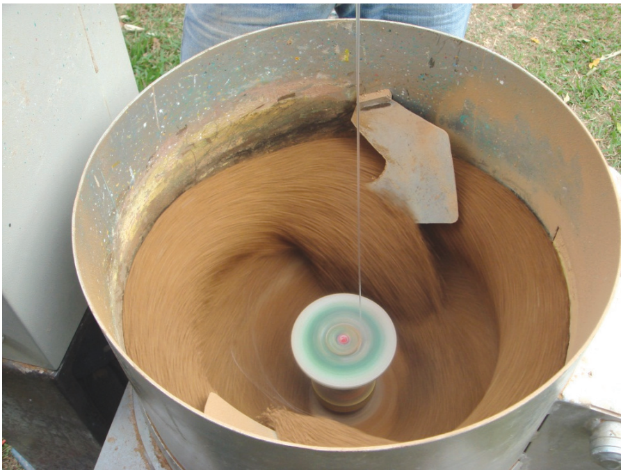
Figura 2. Equipamento comercial para peletização de sementes. As informações sobre o equipamento não são fornecidas pelas empresas produtoras de sementes peletizadas.
