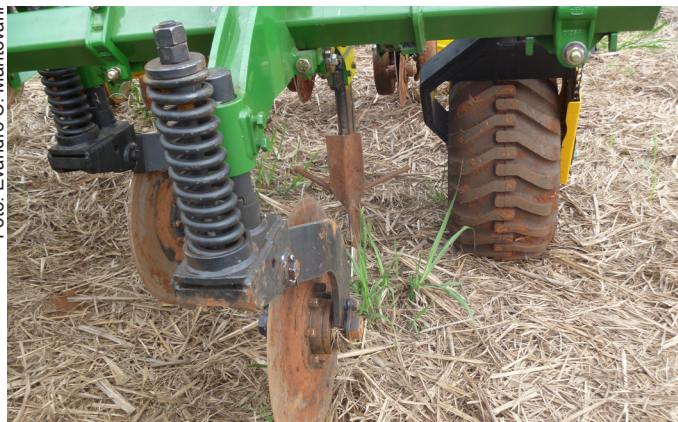
Fig. 1. Disco de corte de palhada e abertura de sulco de plantio.
