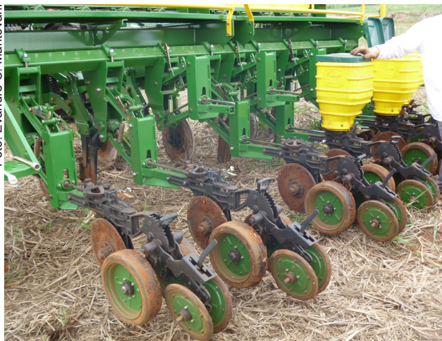
Fig. 6. Sistema de controle de profundidade de sementes com as rodas compactadoras em V.
