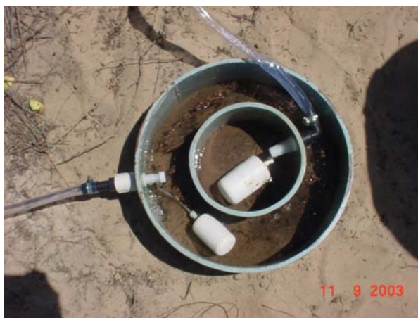
Fig. 19. Duplo Anel Concêntrico utilizado nos testes de infiltração de água no solo.
