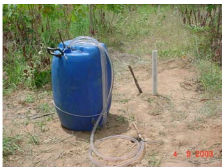
Fig. 12. Teste de condutividade hidráulica na ausência do lençol freático.
