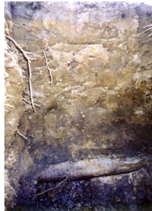
Fig. 4. Posição do dreno no perfil de solo, lote 406.
