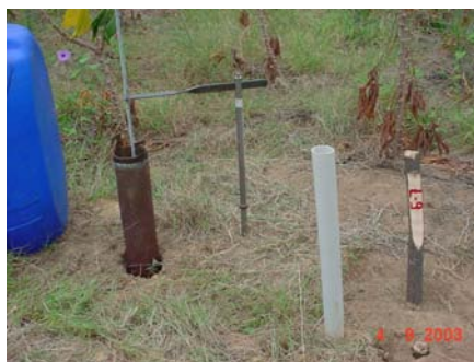
Fig. 13. Teste de condutividade hidráulica na presença do lençol freático.
