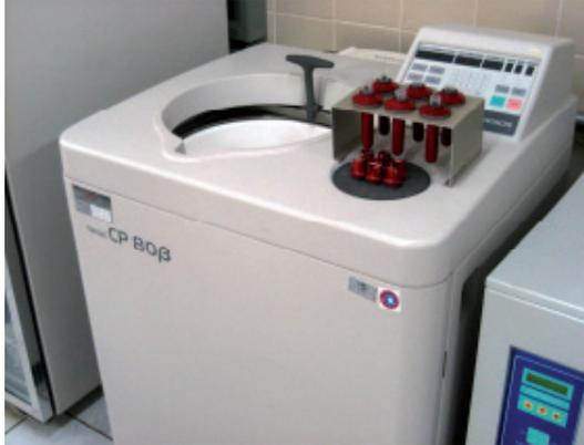
**Figura 2.** Centrifuga modelo Himac CP 80β (Hitashi Koki®, Japão) utilizada no gradiente de sacarose.
