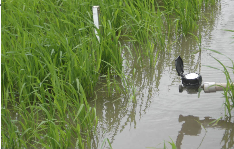
Figura 2 - Entrada de água controlada e régua de medição da lâmina d'água de uma parcela de cultivo de arroz da Embrapa Clima Temperado, Estação Experimental Terras Baixas.
