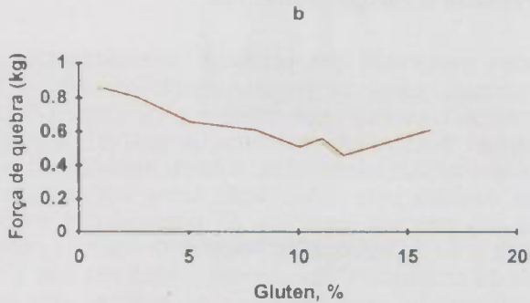
Figura 9b. Variação da força de quebra de extrudados de amido de trigo com vários níveis de glúten adicionado, Faubion (1982).
