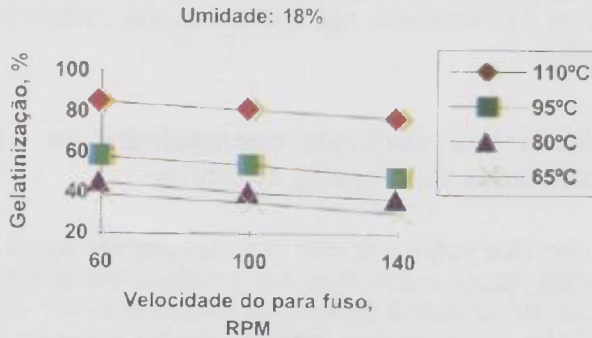
Figura 12a. Efeito da rotação da rosca na gelatinização do amido (18% de umidade), Chiang (1977).
