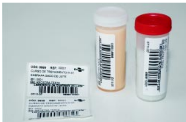
Fig. 8. Etiquetas de código de barras coladas verticalmente nos frascos para identificação das amostras de leite.
