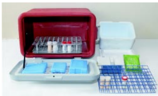
Fig. 2. Caixas isotérmicas (plástico e isopor), gelos recicláveis e estantes para armazenamento e transporte de amostras de leite.
