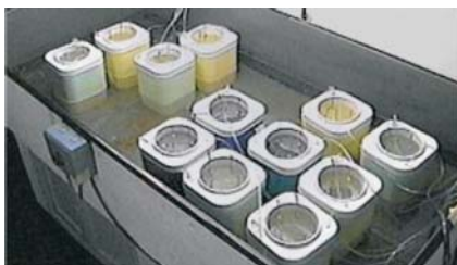
Fig. 3. Visão geral do tanque de banho-maria com a disposição dos potes com solução de Al^{3+} e Ca^{2+} em plântulas de milho. Faculdade de Agronomia/UFRGS, Porto Alegre, 1999. Ana Cristina Mazzocato.
