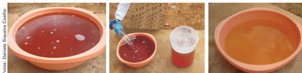
Figura 4. Tratamento do resíduo com H 2 O 2 em grande escala: a) antes; b) adicionando o H 2 O 2 e c) após o processo de oxidação avançada.
