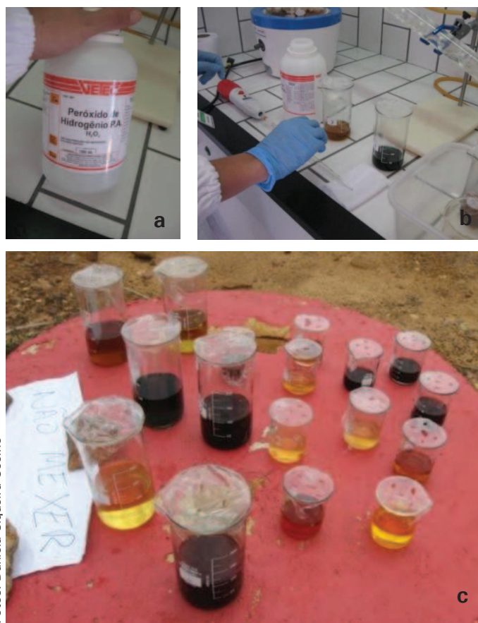
Figura 2. Tratamento da mistura de resíduos orgânicos coloridos oriundos de análises espectrofotométricas: a) \text{H}_2\text{O}_2 (30%); b) adição de \text{H}_2\text{O}_2 e c) exposição das amostras à luz solar.
