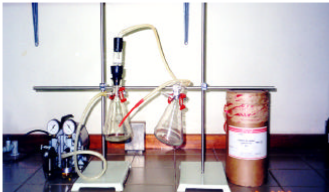
Fig. 2. Aparelho de sucção de frações leves da MOS. A - Ponta de plástico rígido; B - Bomba de vácuo; C - Alternativa ao Sistema Filtragem 'Sterifil' - Filtro de vidro siterizado contendo filtro Whatman GF/A.
