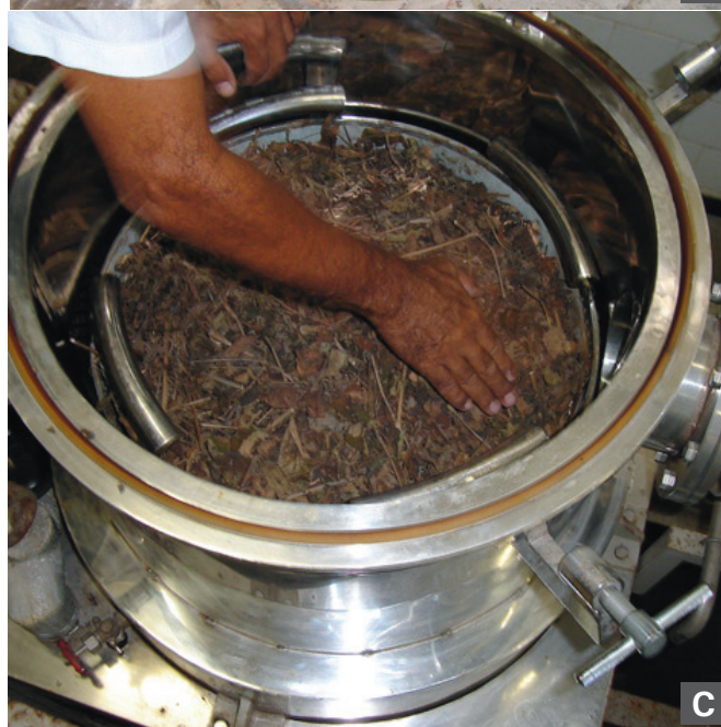
Figura 2. A) operações de separação de folhas e galhos finos; B) enchimento e acomodação no cesto; C) acomodação no extrator de óleo essencial.
