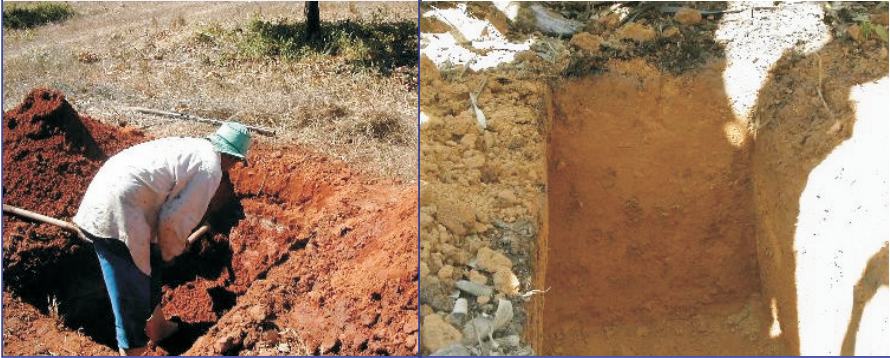
Figura 1. Trincheiras para retirada de amostras de solo no perímetro de irrigação do Gorutuba.
