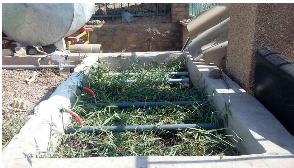
شکل ۱: پایلوت‌های نيزارهای مصنوعی زیر سطحی
