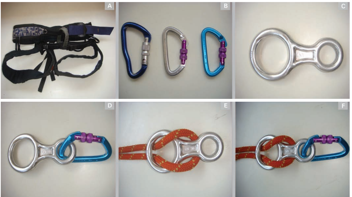
Figura 25. Principais equipamentos utilizados na colheita pelo método de alpinismo/rapel: A) Bouldrier tipo cadeirinha; B) Tipos de mosquetões; C) Freio oito; D) Mosquetão com o freio; E) Freio oito com corda; F) Freio oito com corda e mosquetão; G) Ascender; H) Ascender com corda; I) Fitas tubulares; J) Baladeira (atiradeira), chumbo (peso de pescaria) e fio de náilon; K) Cordas de 10,5 mm; L) Capacete.
