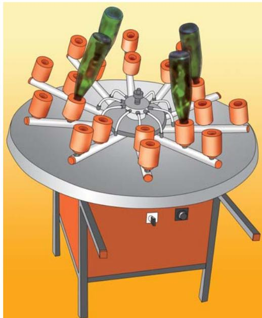
**Fig. 5.** Máquina lavadora de garrafas.
