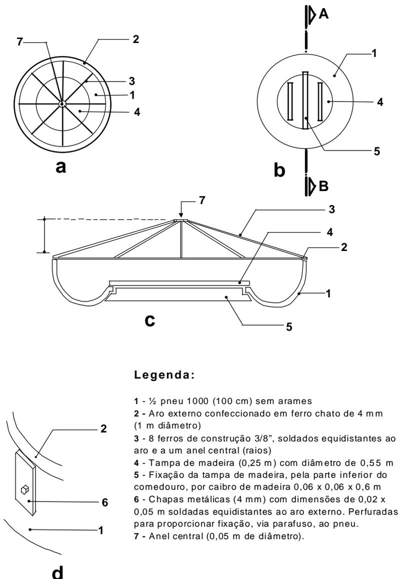
Figura 1 – Comedouro confeccionado com pneu 1000 usado; **a)** Vista superior; **b)** Vista inferior; **c)** Corte AB; **d)** Detalhe de fixação do aro externo do pneu.
