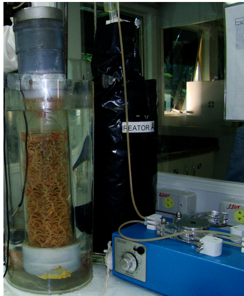
Figura 3. Reator ANAMMOX em escala piloto (2 L) com meio suporte sólido, aclimatado com lodo de uma lagoa anaeróbia, em operação na Embrapa Suínos e Aves.
