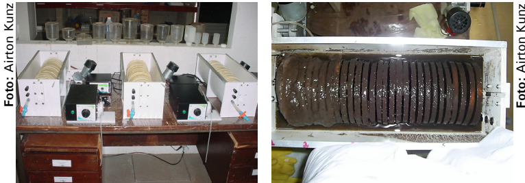
Figura 1. Biodiscos utilizados no estudo sem crescimento (esquerda) e após o crescimento da biomassa (direita).
