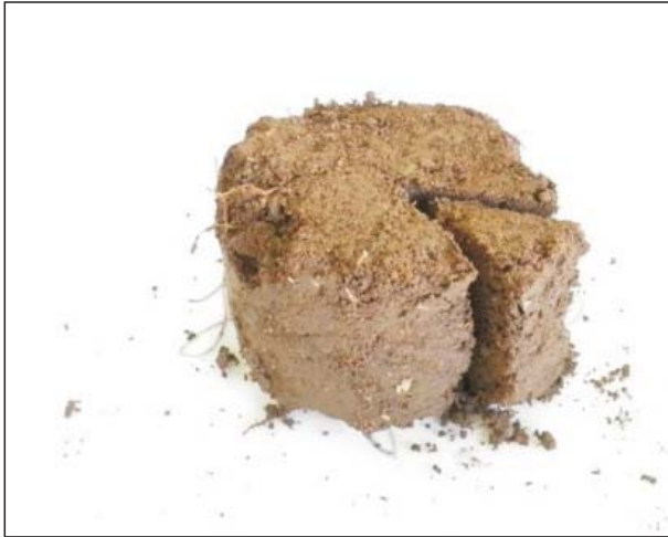
Figura 5. Representação da retirada de 1/8 da amostra para o posterior escaneamento.
