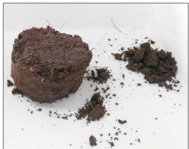
Figura 4. Cilindro de solo com 5 cm de altura proveniente da separação das subamostras.
