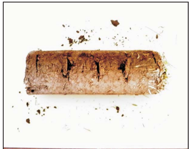
Figura 3. Amostra retirada do cilindro amostrador e com as marcas a cada 5 cm para a separação das subamostras.
