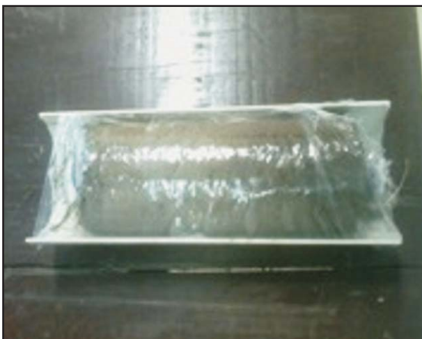
Figura 2. Amostra de solo contendo raízes devidamente acondicionadas após a coleta.
