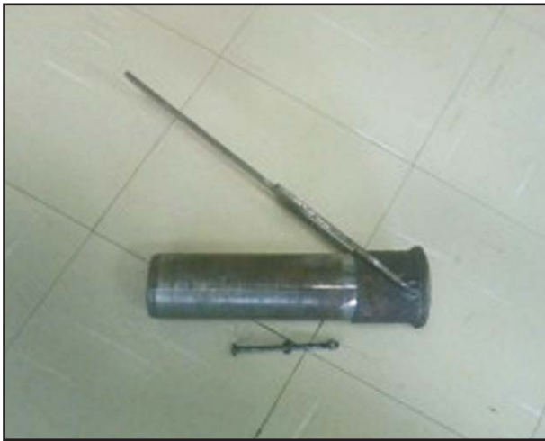
Figura 1. Trado adaptado para coleta de amostras de solo para determinação de atributos de raízes.
