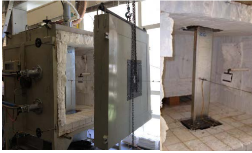
Fig. 12 – Forno de resistência ao fogo utilizado nos ensaios.
