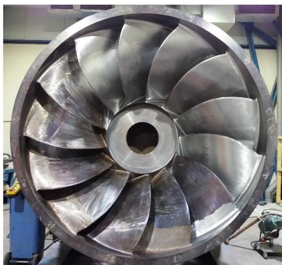
*Figura 29 - Rotor de uma turbina hidráulica Francis.*
