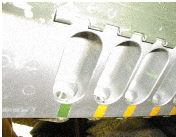
Figura 5. 8 - WS54/55: Furações das secções de encastramento das asas na fuselagem
