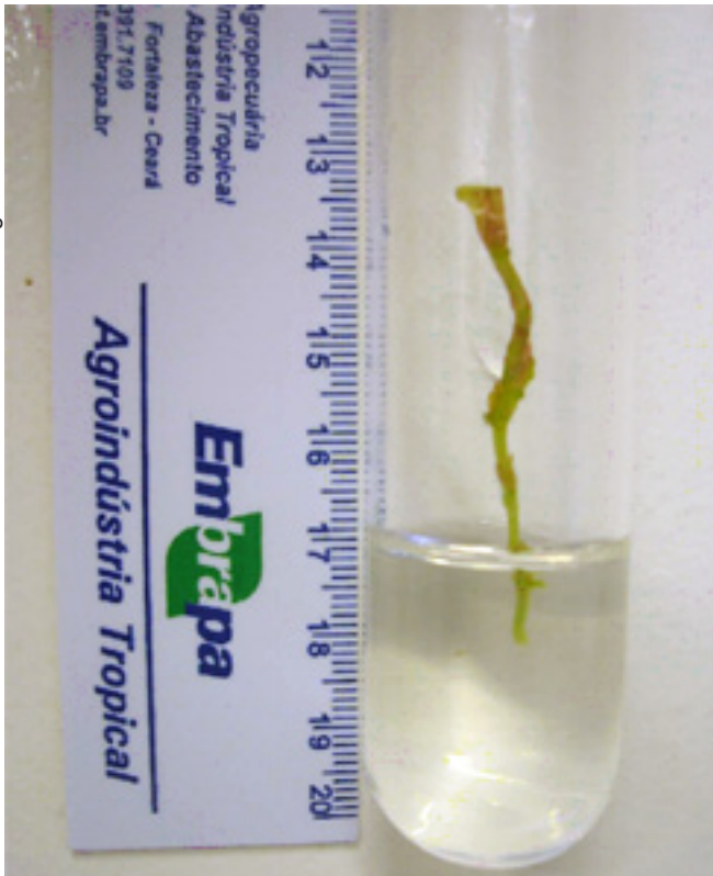
Figura 7. Segmento caulinar (microestaca) de antúrio cv. Eidibel, com tamanho de aproximadamente 5 cm, contendo, em média, de três a cinco nós, totalmente desfolhado.
