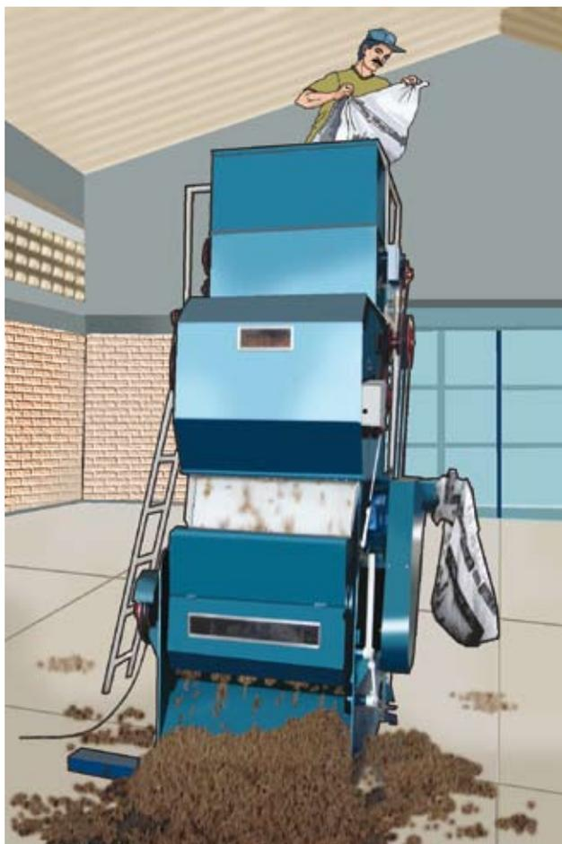
**Figura 4.** Vista frontal da miniusina: detalhe do abastecimento, na parte superior, e na lateral, saco para coleta dos resíduos da limpeza do algodão em caroço.
