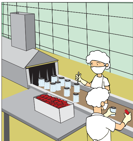
Figura 24. Controle de temperatura e fechamento hermético dos potes na saída da exaustão. Detalhe do controle de temperatura na saída da exaustão (ao lado), que deve ser um ponto crítico de controle (PCC) da qualidade.
