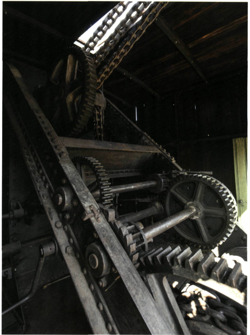
Voor het toppen van de kraanarm werd een dubbele Galle-ketting gebruikt (foto O. Pauwels)
