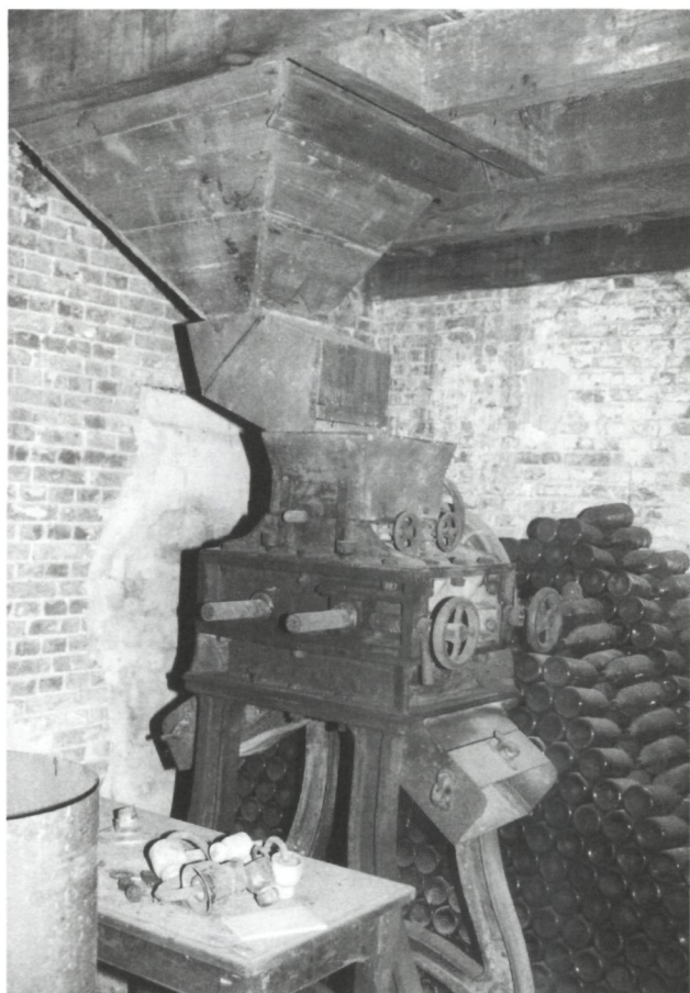
Gietijzeren moutpletbreker in de brouwerij-mouterij Brosens in Hoogstraten (foto J. De Schepper)
