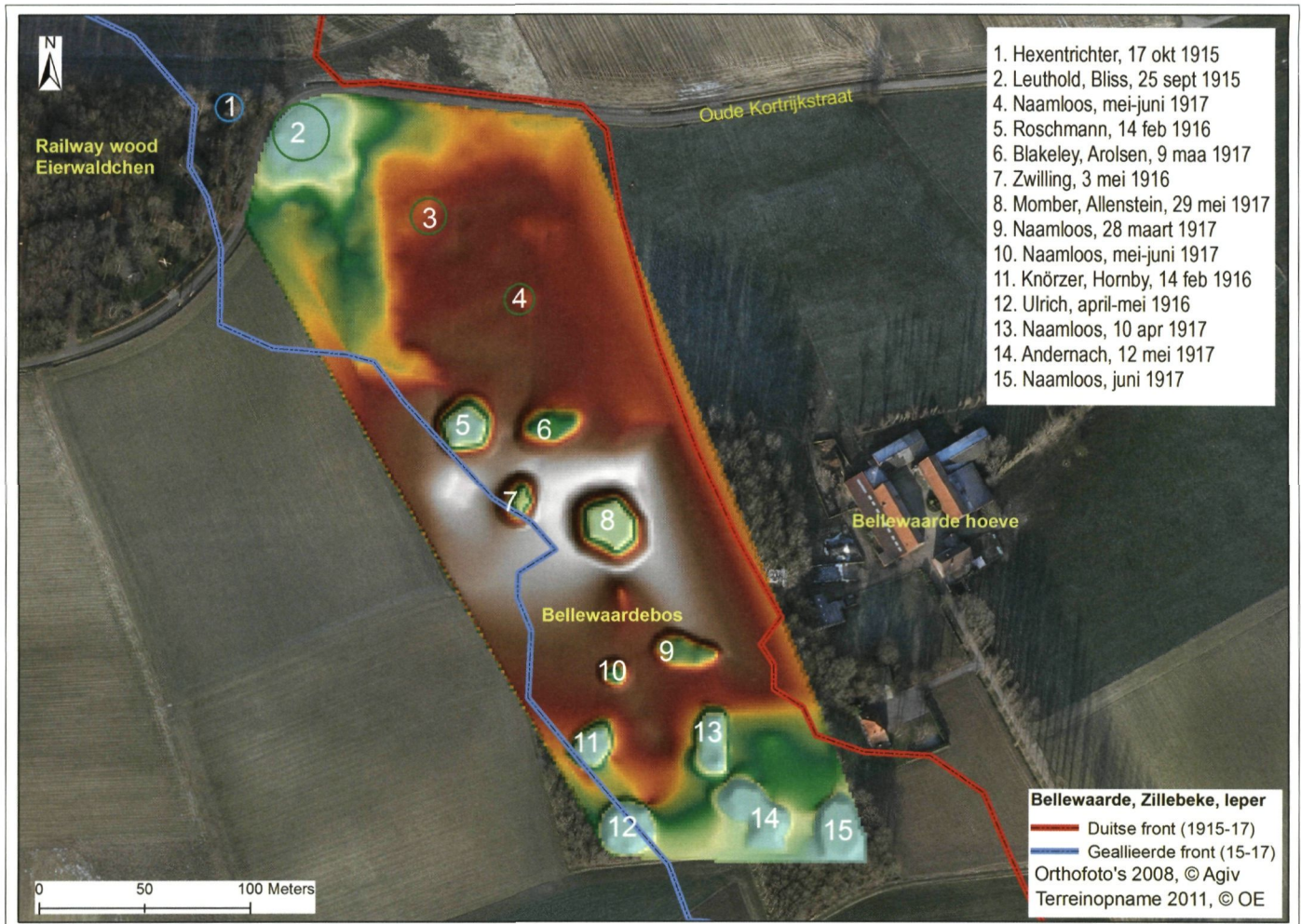
Relicten van de mijnenoorlog 1915-1917. Topografische opmeting van de nog zichtbare mijnkraters bij Bellewaarde (J. Van Laecke en H. Verboven, © orthofoto AGIV)
