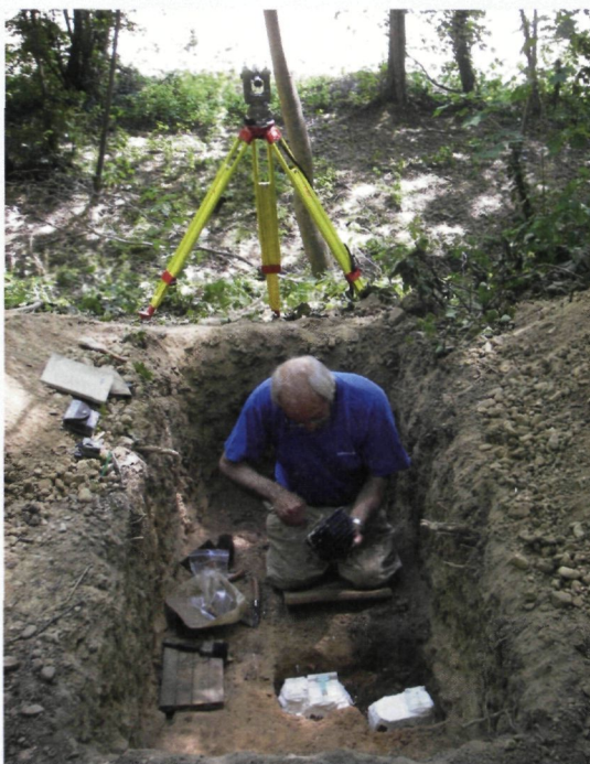
Het nemen van stalen voor paleomagnetische datering (foto M. Verhoeven)
