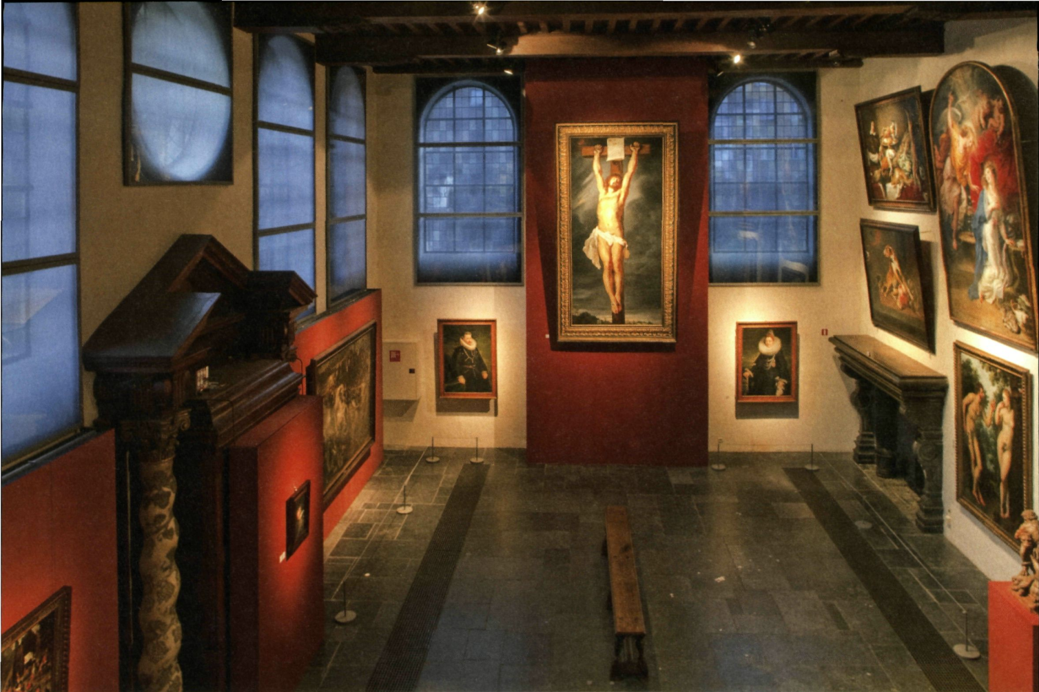
Het interieur van het schilderhuys . Voor de vloer werden zerken van blauwe hardsteen hergebruikt, die afkomstig waren van het Schoonselhof (foto O. Pauwels)
