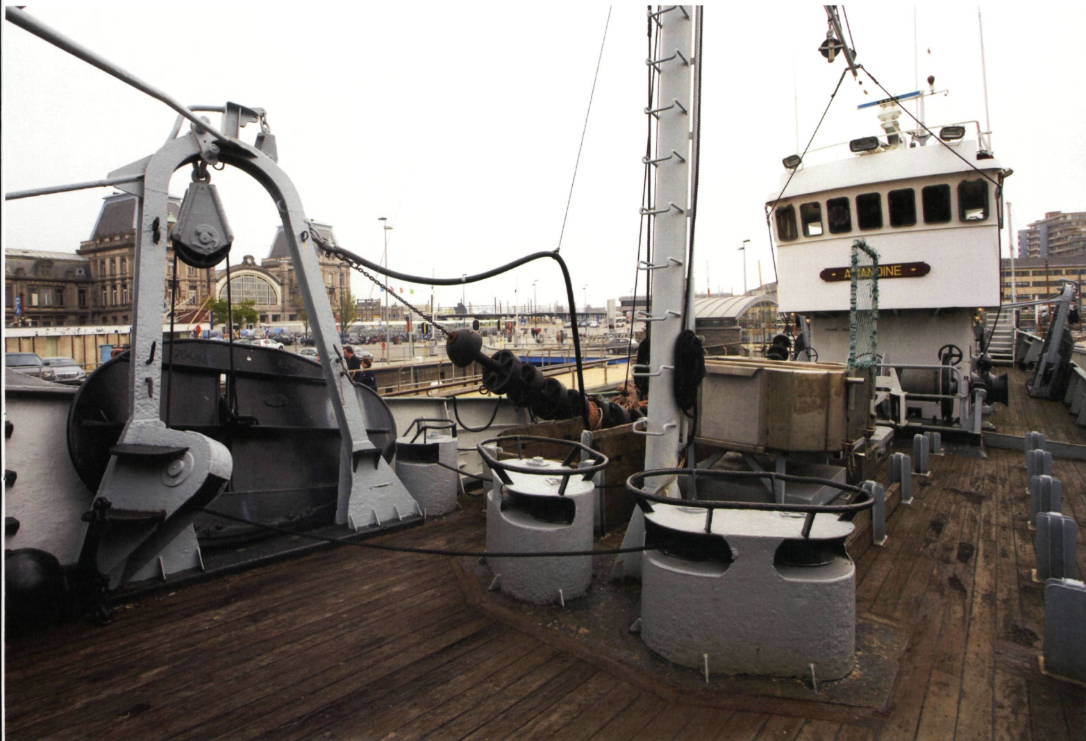
Zicht op het dek, waar de kabels via keer- en geleidingsblokken van de vislier tot de galg werden geleid. De vis werd gesorteerd in bakken vlak achter de mast (© OE, Kris Vandevorst)
