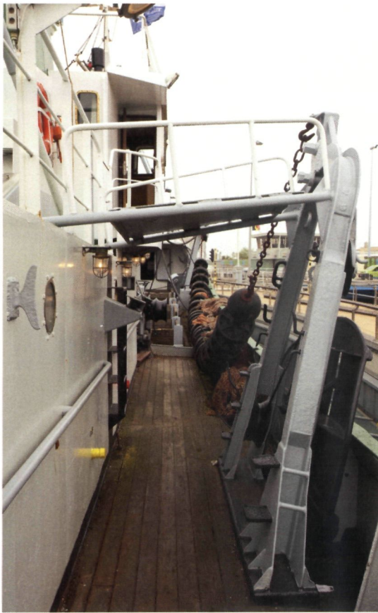
Gangboord met visgalg en scheerbalk. De Amandine was een zijtreiler, wat betekent dat met de bordennetten over één zijde van het schip werd gevestigd. Naarmate de snelheid van het schip toenam, trokken de borden het net open (© OE, Kris Vandevorst)
