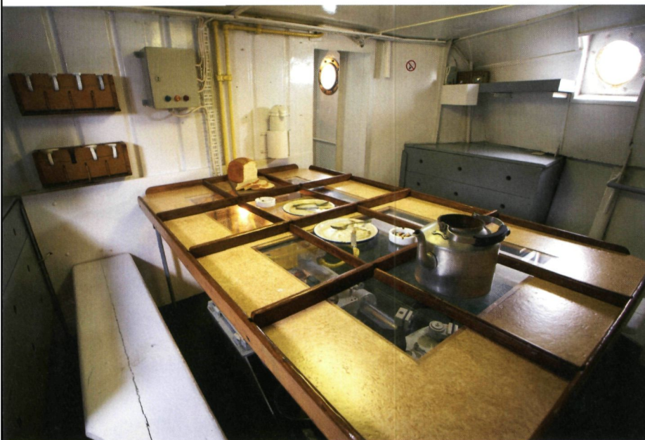
De eetplaats achteraan het schip. Om plaats te besparen werd de hydraulische stuurinrichting onder de tafel geïnstalleerd (© OE, Kris Vandevorst)
