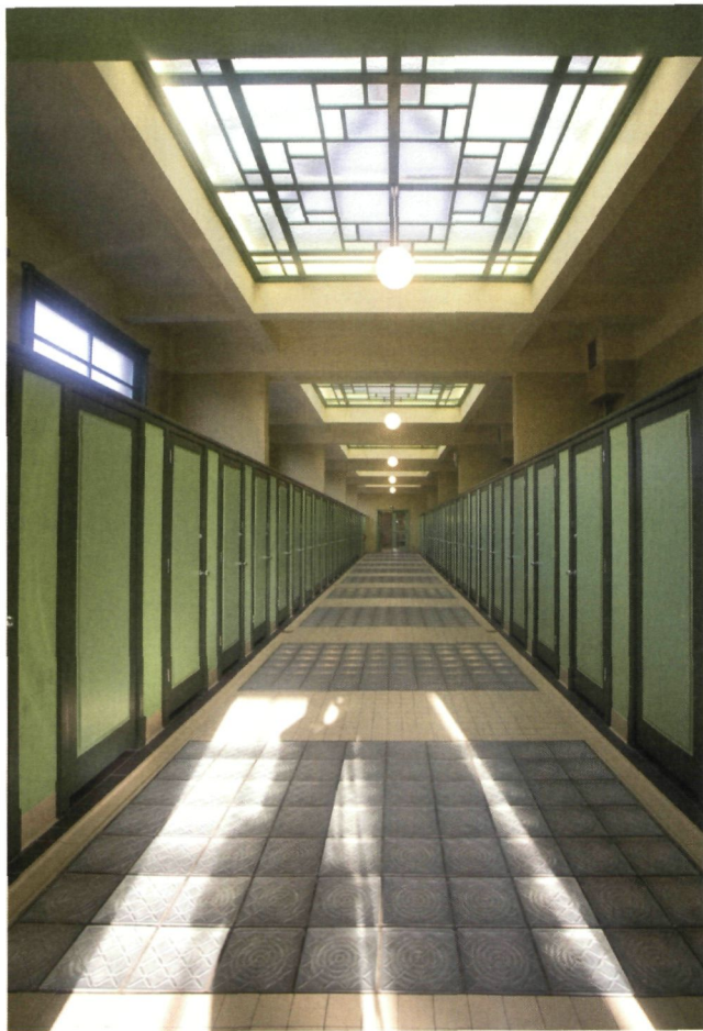
Gereconstrueerde kleedkamers met gebruik van replicamaterialen: binnenschrijnwerk, gehamerd en kathedraalglas, glasbouwstenen, vloertegels en bolpendelarmaturen. Kleurstelling volgens de resultaten van het kleuronderzoek van Studiebureau Lode De Clercq (foto O. Pauwels)
