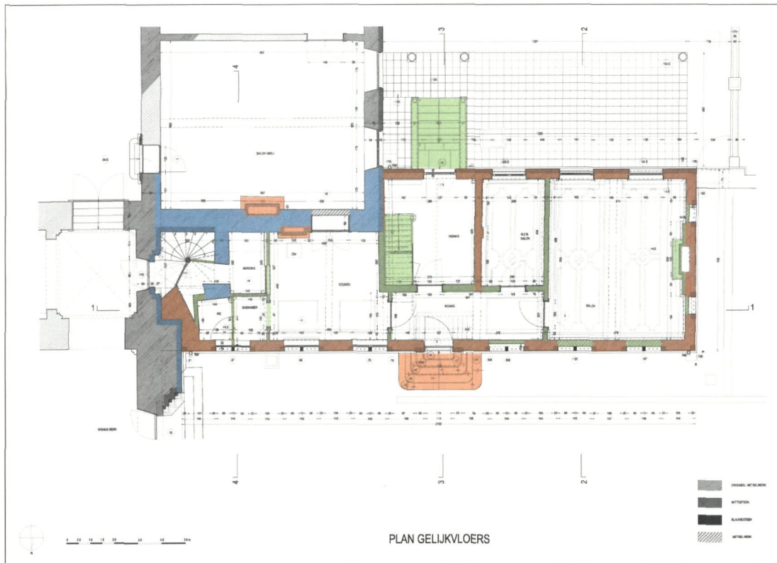
Historisch fasenplan van het gelijkvloers: in blauw de oudere gebouwen, in zalmkleur de 18 de -eeuwse bouwphase van het locutorium, in groen de wijzigingen van rond 1900 (tekening P. Stevens en Studiebureau Monumentenzorg)
