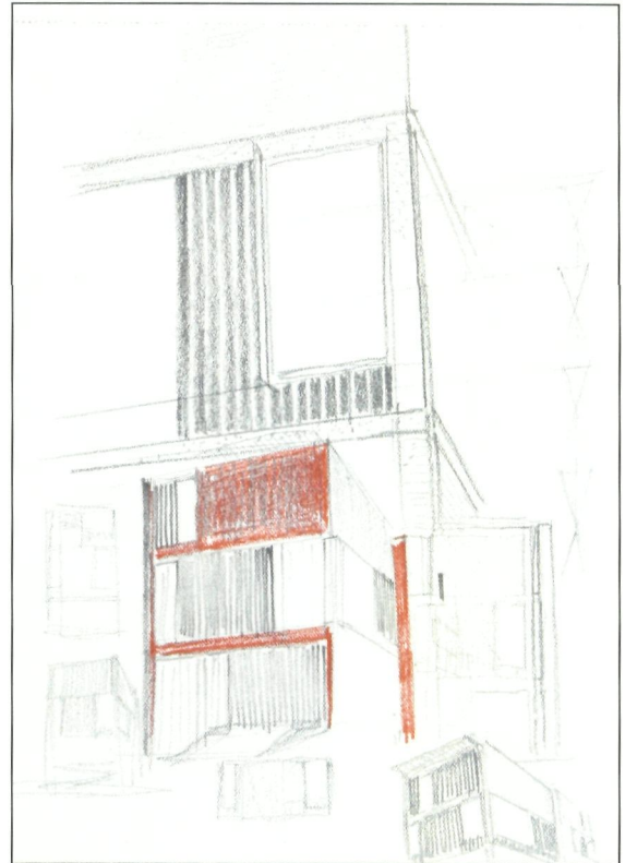
▲ Werkschets voor de eerste versie van het definitieve ontwerp voor de huidige woning, met zichtbare betonstructuur, grijs geëmailleerd metselwerk en rood Kalungi-hout (AML)
