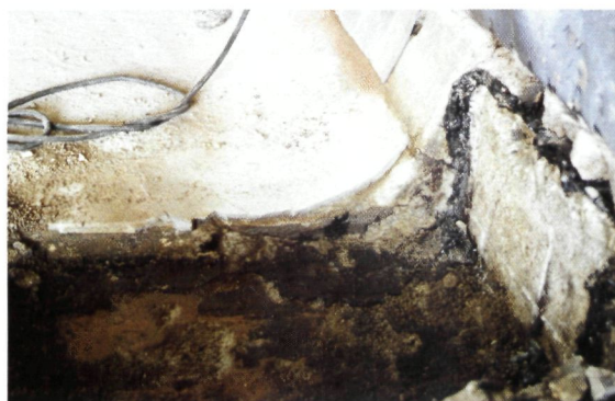
▲ Oorspronkelijke kim (tuingedeelte): de cementering was al hersteld met een extra laag
