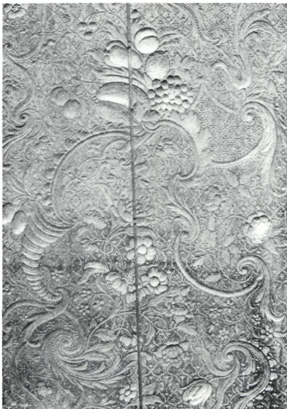
Houten drukplaat waarmee goudleer gedrukt werd (Brussel, Koninklijke Musea voor Kunst en Geschiedenis)
