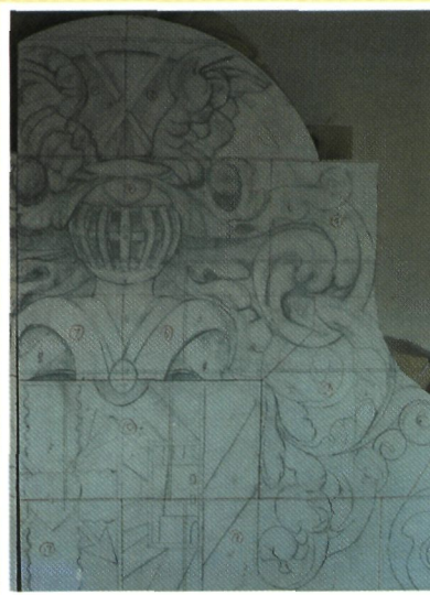
De 17de-eeuwse dakkapel – het gesculpteerde boogveld : Boven links : Toestand vóór de restauratie (foto F. Somers); Boven midden : Detail van de opmetingstekening op ware grootte (foto B.M.L.); Boven rechts : Opstelling in het atelier van de beeldhouwer (foto B.M.L.); Links : Detail van het hermaakte boogveld (foto B.M.L.)
