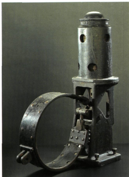
Bandrem van een gesloopte lift van het merk Otis, bouwjaar circa 1920, Otto Veniusstraat 3, Antwerpen (verzameling Konhef, foto G. Charlier)
