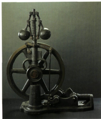
Snelheidsbegrenzer van het type Watt, merk Otis, bouwjaar circa 1920-1950 (verzameling Konhef, foto G. Charlier)
