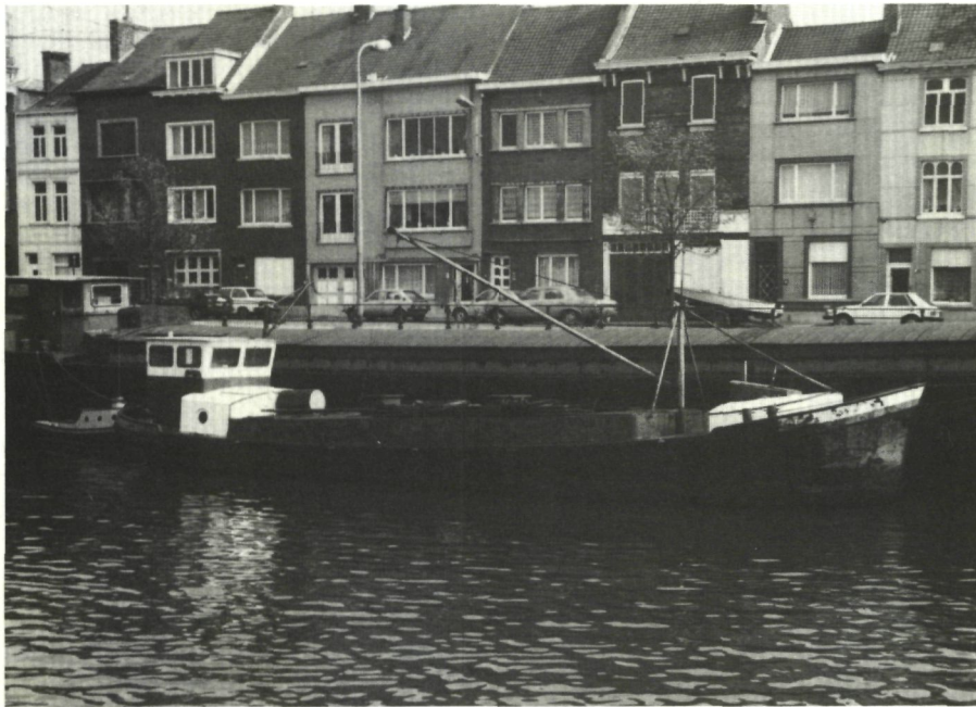
De 'Josée', een klipper van 1906, zoals de auteur haar ontdekte in Gent. Het oude, ranke zeilschip is onmiddellijk — mits wat oefening — herkenbaar. Afmetingen 4,40 bij 18,50 m. Het scheepje was gedurende jaren een mazzoutbevoorrader, eerst rond Boom, dan in Gent. De Zeekadetten verbouwen het momenteel tot motorschip. Bemerkt de typische klipperkop.
