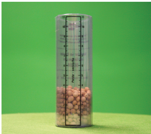
Figura 6. Determinação das perdas de grãos (sacos de 60 kg/ha) na colheita de soja.
