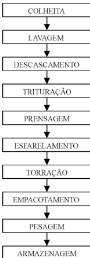
Fig. 4. Fluxograma das etapas de processamento da farinha de mandioca do grupo seca.
