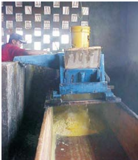
Fig. 6. Trituração da raiz e m triturador mecânico.
