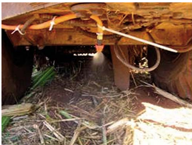
Fig. 4. Bico pulverizador acoplado ao trator e aspersão do produto inoculante.
