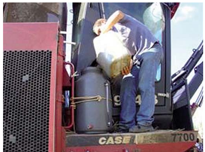
Fig. 3. Pulverização dos colmos recém cortados. Tanque de 200 L acoplado à colhedora de cana-de-açúcar.
