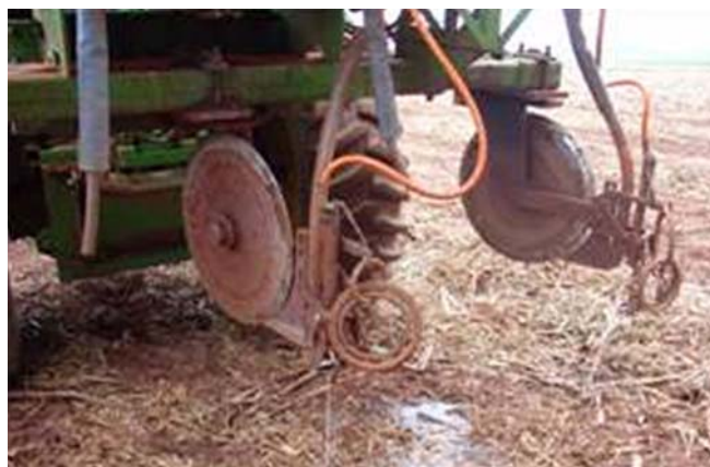
Fig. 7. Aplicador de nematicida (usado para controle de cupim nas soqueiras de cana). O implemento também pode ser empregado para aplicação do produto inoculante.
