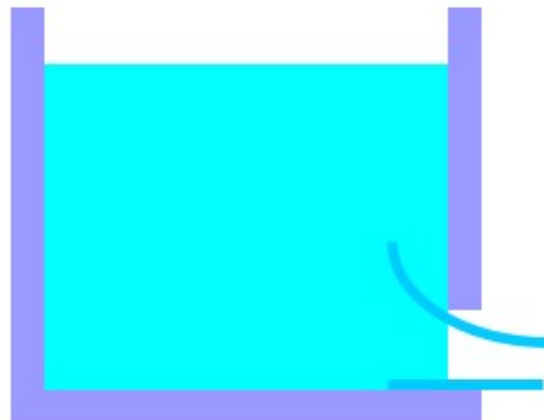
Figura 112 – (a) Contração completa (em todas as faces do orifício); (b) Contração incompleta (só na parte de cima do orifício) (Junior L. B., 2005).
