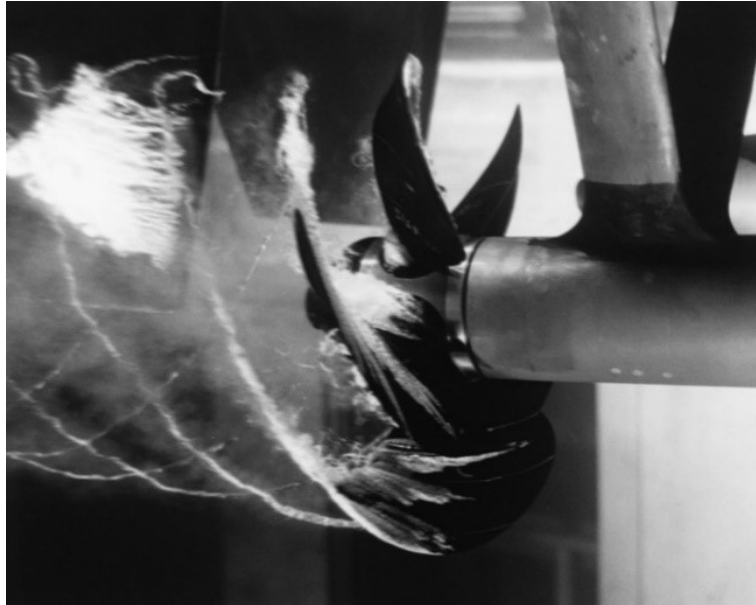
Figura 90 – Modelo de propulsor gerando cavitação num túnel de água experimental ( https://commons.wikimedia.org ).
