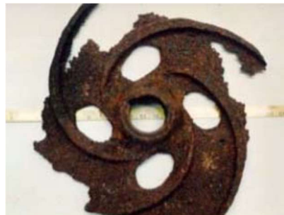
Figura 93 – Rotor danificado pela cavitação, pertencente a uma bomba de água (Oliveira, 2007).
