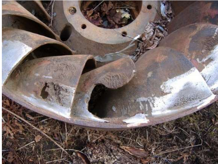
Figura 91 – Danos causados por cavitação numa Turbina Francis ( https://commons.wikimedia.org ).
