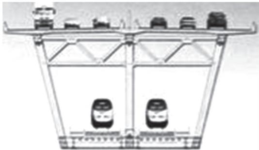
图1 双层桥面主梁断面
