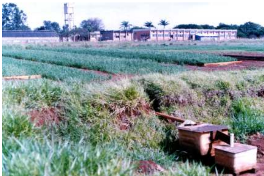
FIG. 1. Vista parcial do sistema de coleta de enxurrada e das parcelas permanentes.
