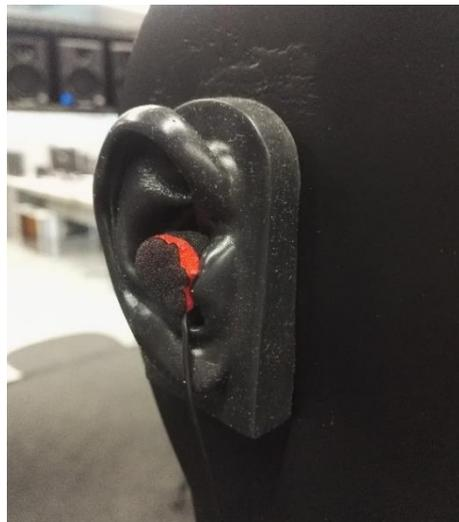
Figura 36. Detalle de uno de los micrófonos binaurales en el simulador de cabeza.
