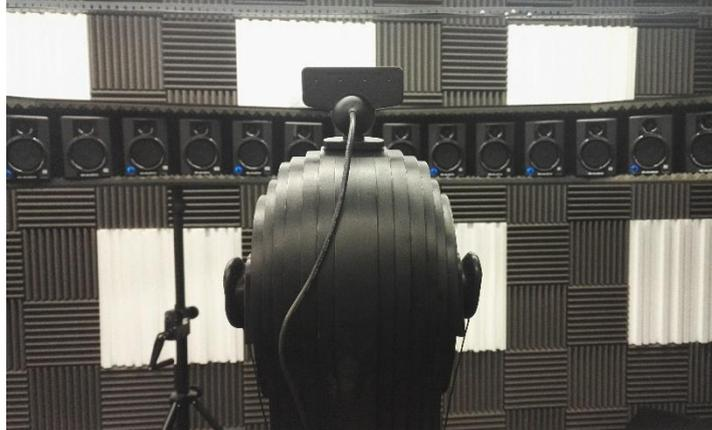
Figura 37. Vista trasera del simulador de cabeza con el dispositivo PS3 Eye situado encima.
