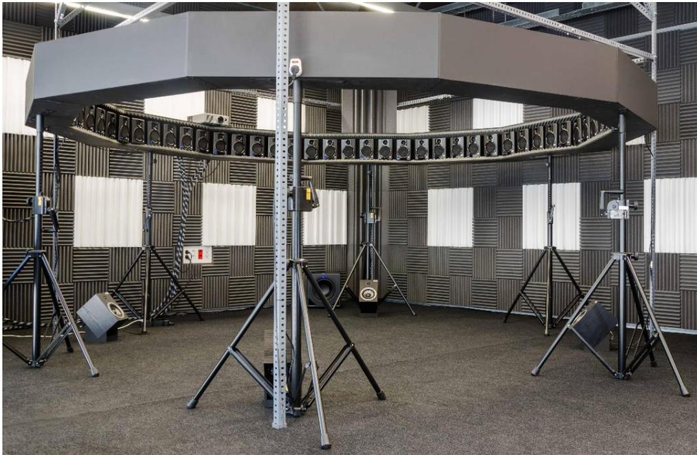
Figura 39. Instalación del sistema de Wave Field Synthesis.
