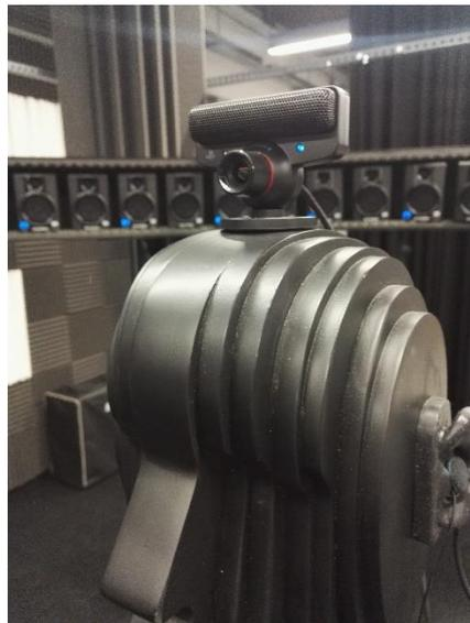
Figura 38. Vista frontal del simulador de cabeza con el dispositivo PS3 Eye situado encima.
