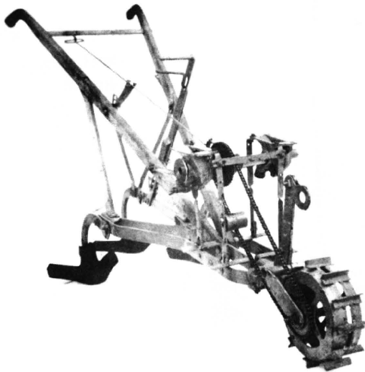
Fig. 6 - Detalhe do acoplamento do distribuidor de fertilizantes
