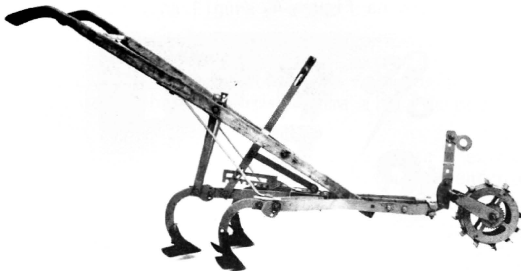
Fig. 1 - Cultivador com roda modificada
