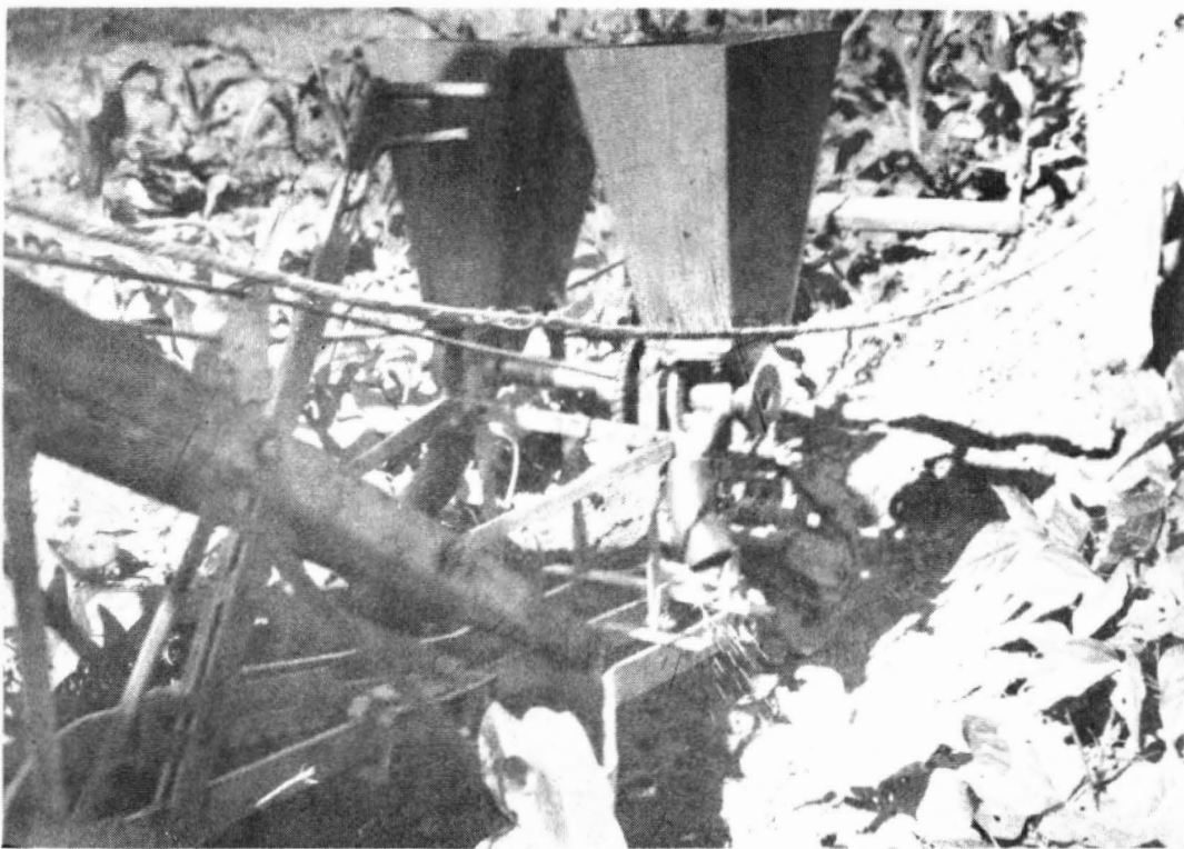
Fig. 11 - O implemento realizando adubação em cobertura e o cultivo
