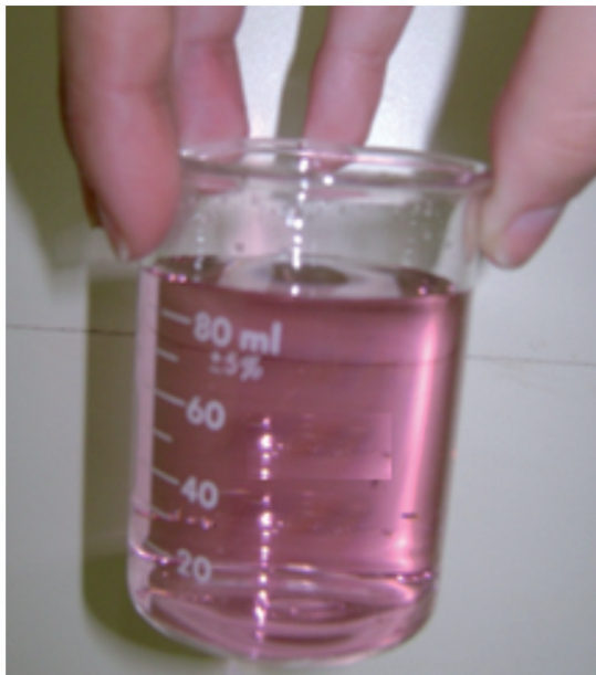
Figura 7. Viragem na titulação para a determinação da dosagem de nitrogênio na amostra.
