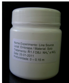
Figura 2. Frasco de PVC que pode ser utilizado para levar a solução extratora de KCl ao campo.
