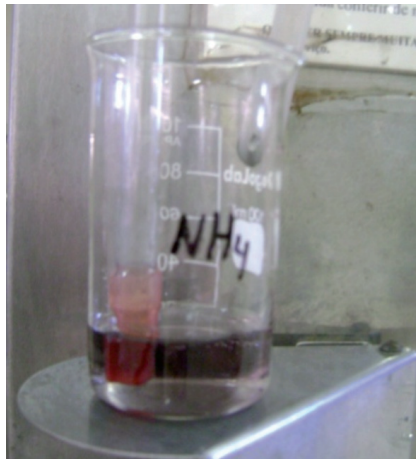
Figura 6. Processo de destilação e formação do borato de amônio.
